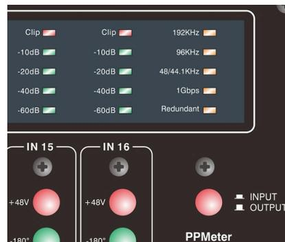
這16組訊號錶除了可以用來監看輸入位準，在前面板右方有個 INPUT/OUTPUT 按鈕，可以讓你將這16組訊號錶切換成監看輸出位準。
