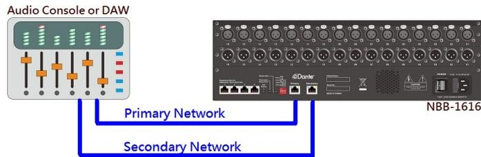
**系統延伸** 因為 NBB-1616 可以將串流音訊穿過網路交換器，所以你可以經由網路交換器來擴大佈局你的 NBB-1616 網路。
