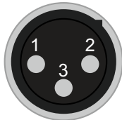
XLR 平衡式接法 1- 腳 (地) ; 2- 腳 (正) ; 3- 腳 (負)
