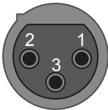
XLR 平衡式接法 1- 腳 (地) ; 2- 腳 (正) ; 3- 腳 (負)
